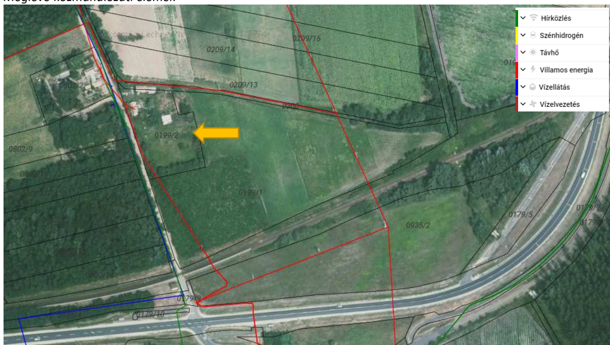
Meglévő közműhálózati elemek
